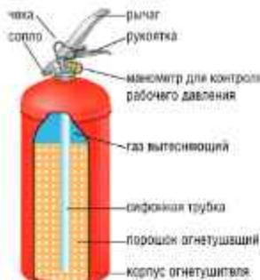
Устройство, заряженное огнетушащим порошком и закачанное газом (воздухом, азотом или углекислым газом).
